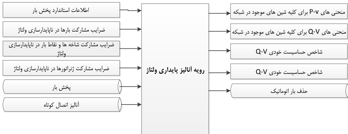
شکل (۲-۹): روندنمای رویه پایداری ولتاژ در سیستم قدرت
